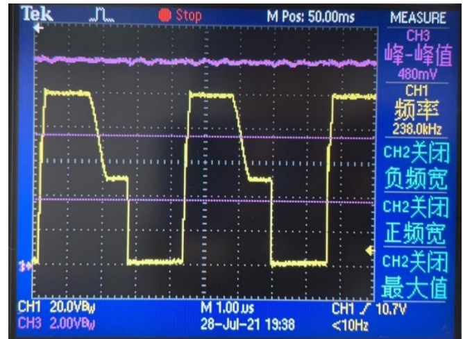
Switch Waveform(VIN = 48V, IO = 2.5A)
